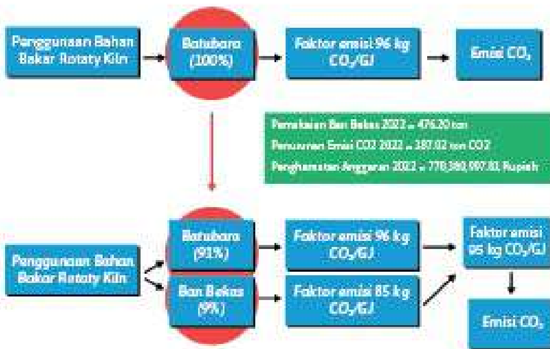
Gambar 8. Skema penggunaan bahan bakar di rotary kiln sebelum Inovasi (atas) dan setelah Inovasi (bawah)
