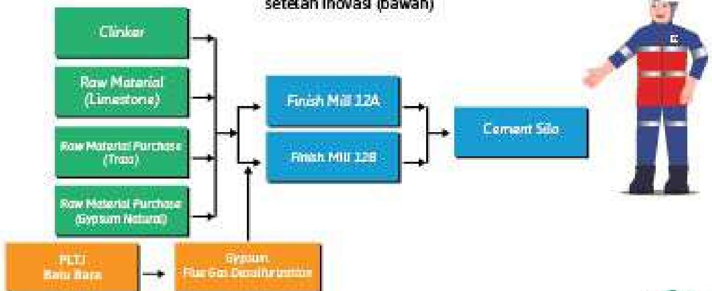
Gambar 1. Skema Proses Pembuatan Semen di Finish Mill sebelum Inovasi (atas) dan setelah Inovasi (bawah)
